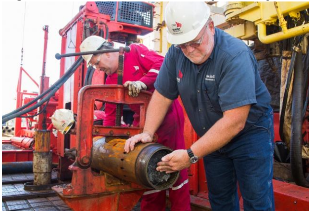
La première carotte géante remontée avec un outil de nettoyage du puits
