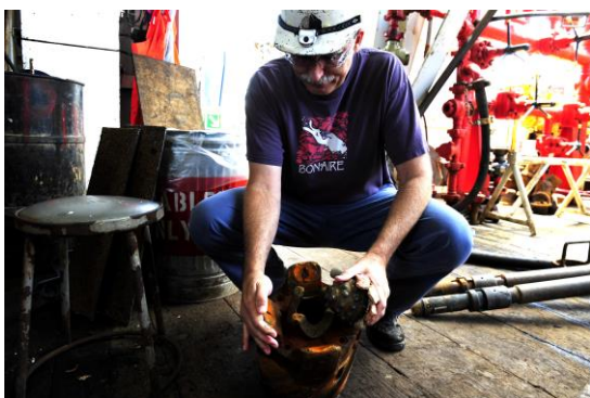
Steve fait l'inspection de la tête de forage endommagée
