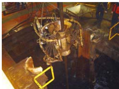
La caméra est prête à descendre le long de la tige de forage pour repérer le puits
