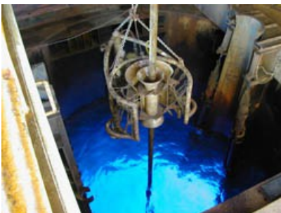
la caméra va descendre... On appelle ce trou au milieu du bateau la "moon pool" (la "piscine de la lune")
