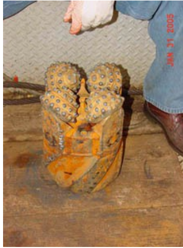
Un trépan après 50 heures de forage
