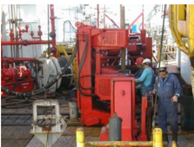
On visse les éléments de la tige...
