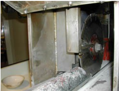
Découpage des carottes à la scie
